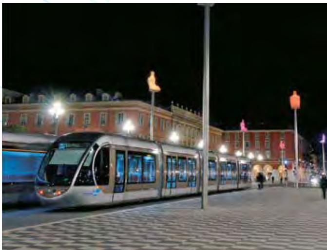
Place Massena, le tramway fonctionne sur une partie de son itinéraire grâce à une propulsion autonome par batterie.
