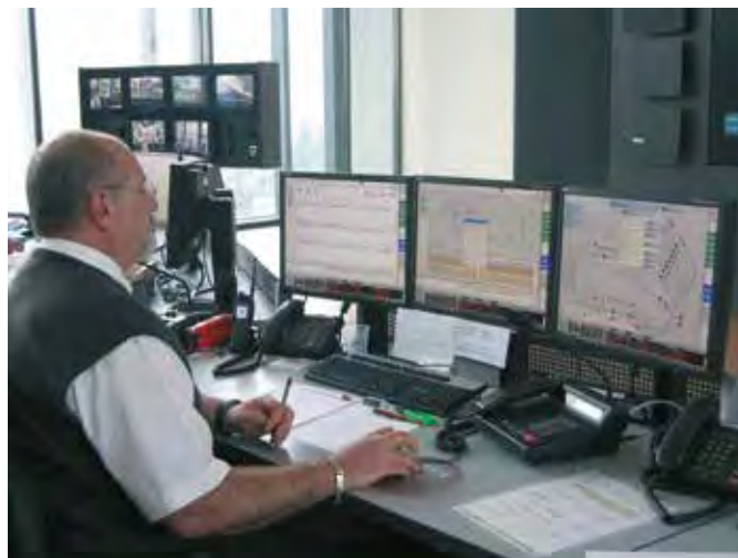
Poste opérateur : Interface Panorama E 2 permettant de gérer plusieurs applications externes : vidéo surveillance, signalisation, informations voyageurs, ect.
