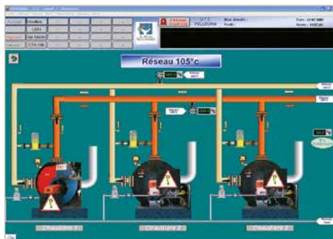
Vue synoptique Panorama correspondant à la supervision des chaudières de l'hôpital de Pellegrin
